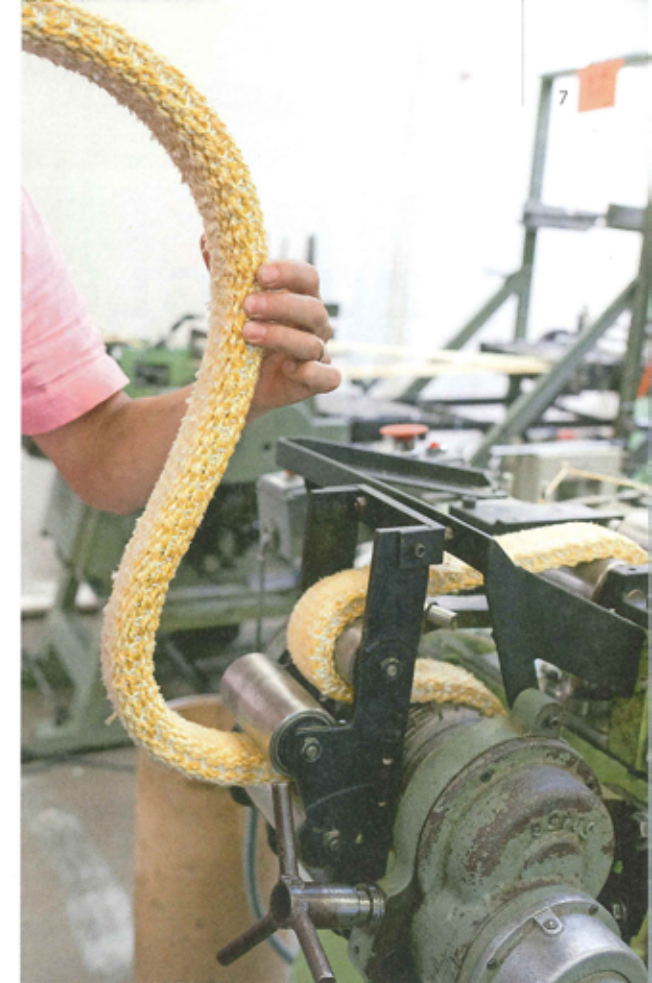
Temperaturbeständig bis zu 850 Grad: ein gewobenes Isolationsband aus Glas.
